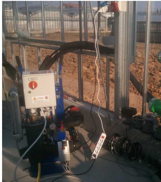
Figura 4-12: Dispositivo TRT Dime/Erde operante presso il la serra laboratorio Sam Lab di Albenga
