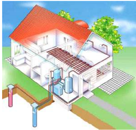
Figura 3-9: Rappresentazione di sistema geotermico a circuito aperto
